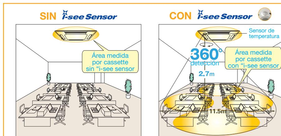
**EFFECTO:** El modo "Ajuste Automático de la Velocidad del Aire" distribuye el aire por todo el local y el i-see Sensor detecta la temperatura del aire al nivel del suelo y paredes.
